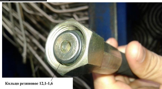
Рисунок 3 – Установка резинового кольца КУН 2000.00.005
